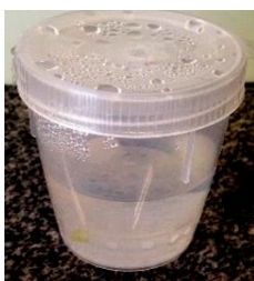
Figura 7- Frasco adaptado para teste de liberação de ibuprofeno a partir de pastilhas da MCM-41.
